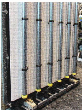
Die Testserie erfolgte an einer Prüfwand, an der sechs Fallrohre mit unterschiedlichen Befestigungsarten montiert waren.
