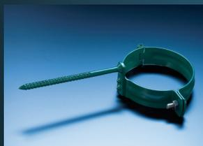
**Schritt 4:** **Tipp:** Ideal sind Rohrschellen mit 150 mm Schlagschraubdorn. Auch Schlagdorne (ca. 7/7 mm) und Schellen mit Holzgewinde sind möglich. Teflonspray oder Spülmittel erleichtern den Einbau. Bei Schlagdornen ist ein fester Wanduntergrund erforderlich.
