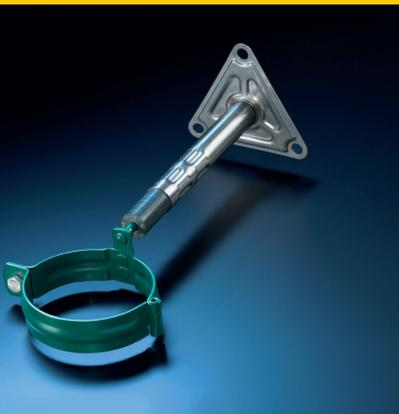
Der STG Rohrschellenhalter wird am Mauerwerk bzw. an der Wandkonstruktion vor der Herstellung der Fassade montiert. Dadurch ist nach der Fertigstellung der Fassade (Vollwärmeschutz und hinterlüftete Systeme bis 300 mm!) eine einfache und dauerhafte Befestigung von Rohrschellen etc. möglich.
