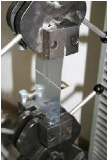
Prüfung der Folie/Siegelnaht
