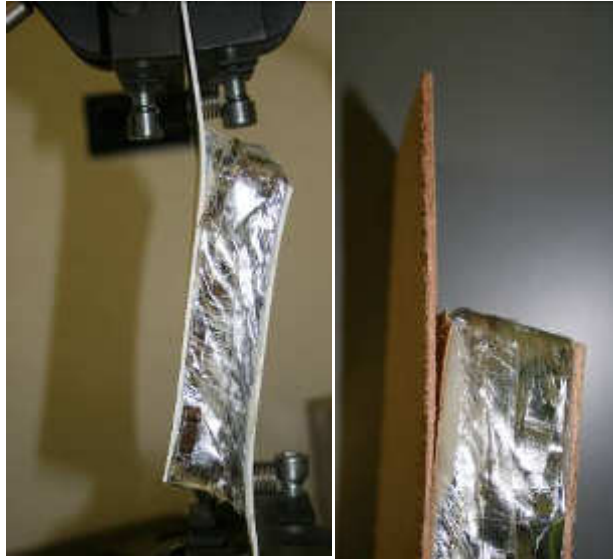
Prüfung der Verklebung bis zum Materialbruch
