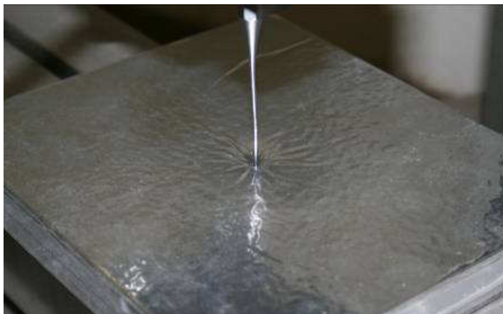
Prüfung der Durchstoßsicherheit der Hochbarrierefolie
